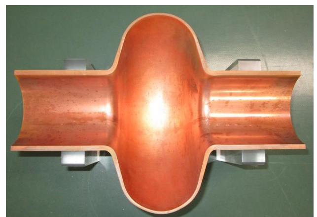
切断した空洞内部
