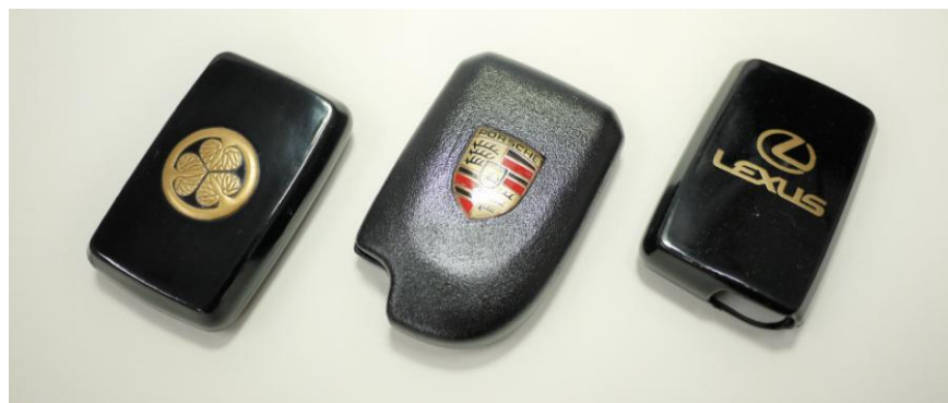
漆を使用した樹脂の加工例
